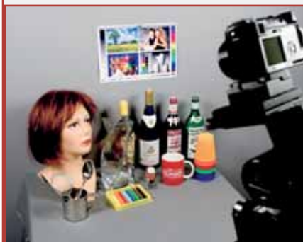
Scena testowa, przygotowana do sfotografowania. Ujęcie wykonujemy przy dwóch ustawieniach jasności lamp fluorescencyjnych.
