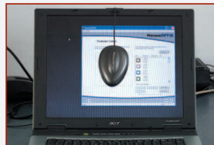
Do pomiarów jakości odwzorowania barw notebookowych paneli LCD użyliśmy spektrofotometru monacoOPTIX XR PRO .
