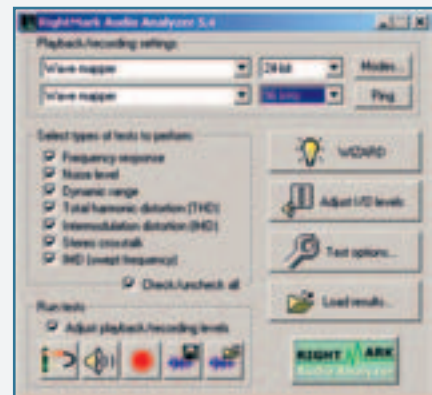
Jakość sygnału audio generowanego przez zintegrowane z płytami głównymi karty dźwiękowe badaliśmy za pomocą programu RightMark Audio Analyzer 5.4.
