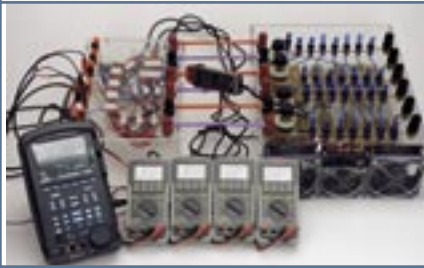
Skonstruowane przez nas stanowisko pomiarowe umożliwia dokonywanie testów zgodnie z zaleceniami normy ATX12V v2.2.
